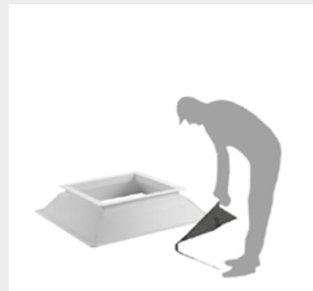
Cubrir toda la parte exterior del zócalo con lámina impermeable.
